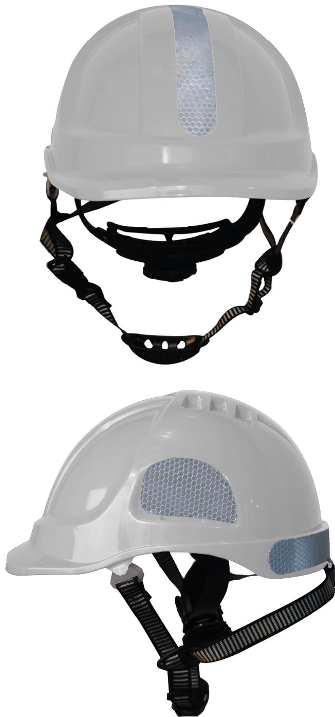
Cascos tipo II para trabajo de alturas, espacios confinados y/o eléctricos, e industria en general, fabricado en termoplástico ABS de alta resistencia a golpes laterales y verticales. Cuenta con perilla de ajuste de trinquete y enganche de cinta de 6 puntos.
