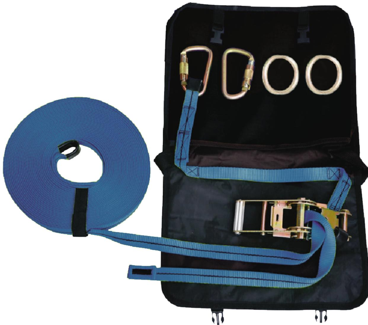
Línea de vida horizontal temporal personal de 2 a 20m (6 to 65.5ft) de largo. Se puede conectar a un dispositivo de anclaje y el tensor de tipo ratchet se utiliza para proporcionar la tensión al sistema después de ajustar la distancia requerida. Adecuado para usarse con dos personas simultáneamente.
