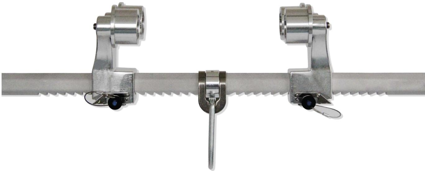
Anclaje deslizable para vigas, removible tipo "I" con 2 lados ajustables en ambos extremos. Fabricado con aluminio y acero inoxidable, cuenta con 1 anillo "D" giratorio de acero y 4 ruedas.
