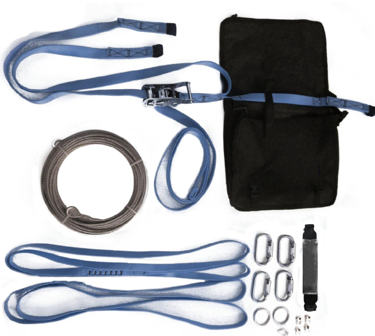
La Línea de Vida Temporal de Cable Horizontal cuenta de 2 a 22.5 m (6.5 to 65.6ft) y mantiene al usuario asegurado durante sus desplazamientos. Puede ser atado a un dispositivo de anclaje. El tensor tipo ratchet sirve para dar tensión a la línea después de ajustar la distancia. Uso para 2 personas.
