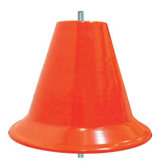
El Cono Scope Multi<sup>®</sup> es la mejor solución para sistemas de línea de vida anticaída sobre techos. Una de las principales características es su forma cónica ya que utiliza el material de manera eficaz para deformarse y absorber energía, adicionalmente cuenta con un absorbedor interno diseñado para limitar la fuerza en la estructura en caso de una caída. El dispositivo se atornilla a los diferentes tipos de placas base (Cuadrada, de Cruz, Redonda y Rígida) según el tipo de cubierta.
