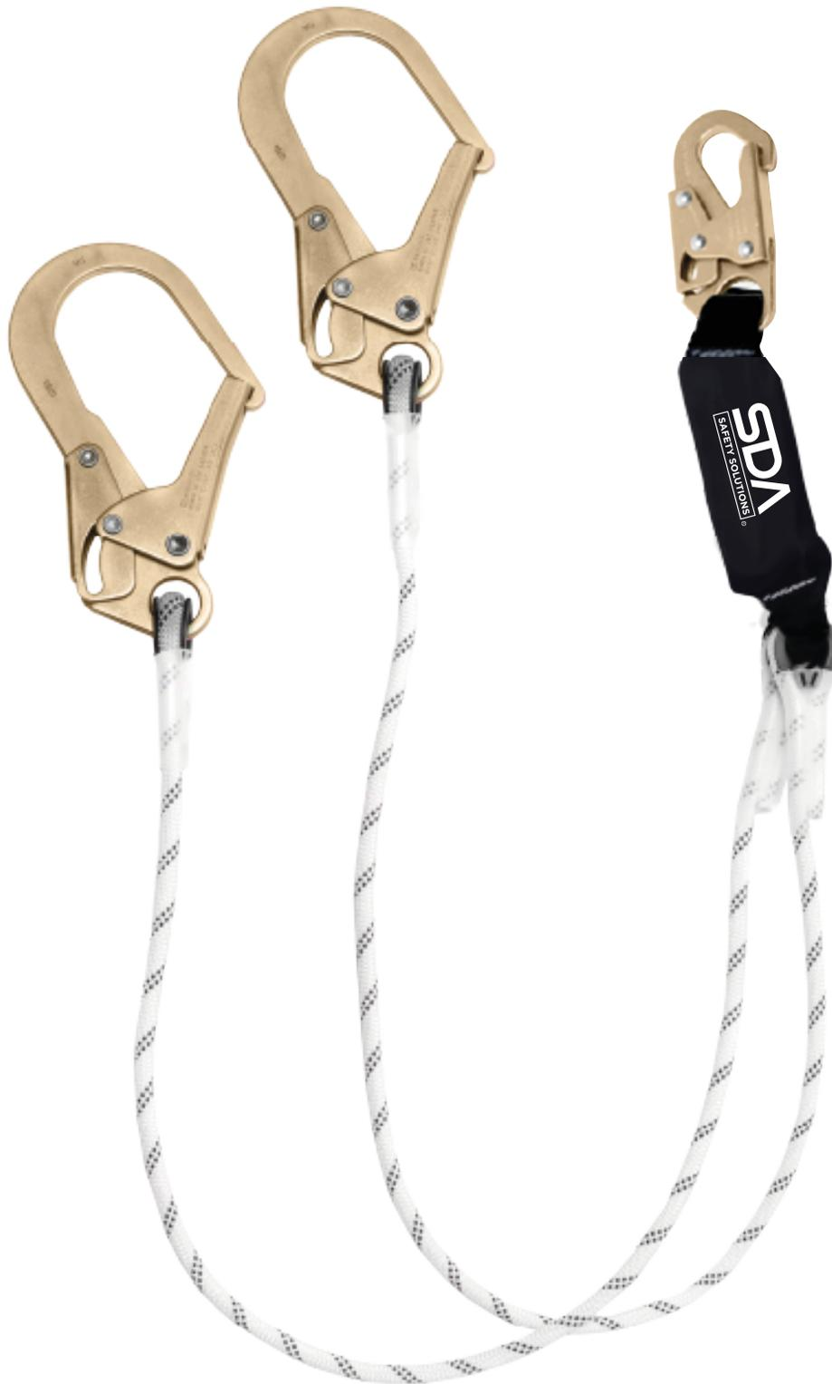
Amortiguador de Impacto contra caídas elaborado con cuerda Kernmantele de alta tenacidad de 7/16" (11mm) de diámetro. Longitud 1.8m (6ft), con tres ganchos de acero de 1 x 3/4" & 2 x 2 1/4" de apertura.
