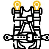
**Anillos D para los hombros:** este par de anillos D, que normalmente se encuentran en la parte superior de los hombros del usuario, se utilizan junto con una barra separadora para facilitar la entrada y/o el rescate en espacios confinados, de modo que el cuerpo del usuario permanezca erguido.
