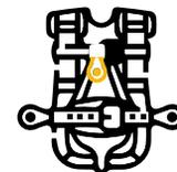
**Anillo D externo:** ubicado en el centro del pecho del usuario, este anillo D está diseñado para crear un punto de sujeción a sistemas verticales utilizados para ascenso y descenso por escaleras.
