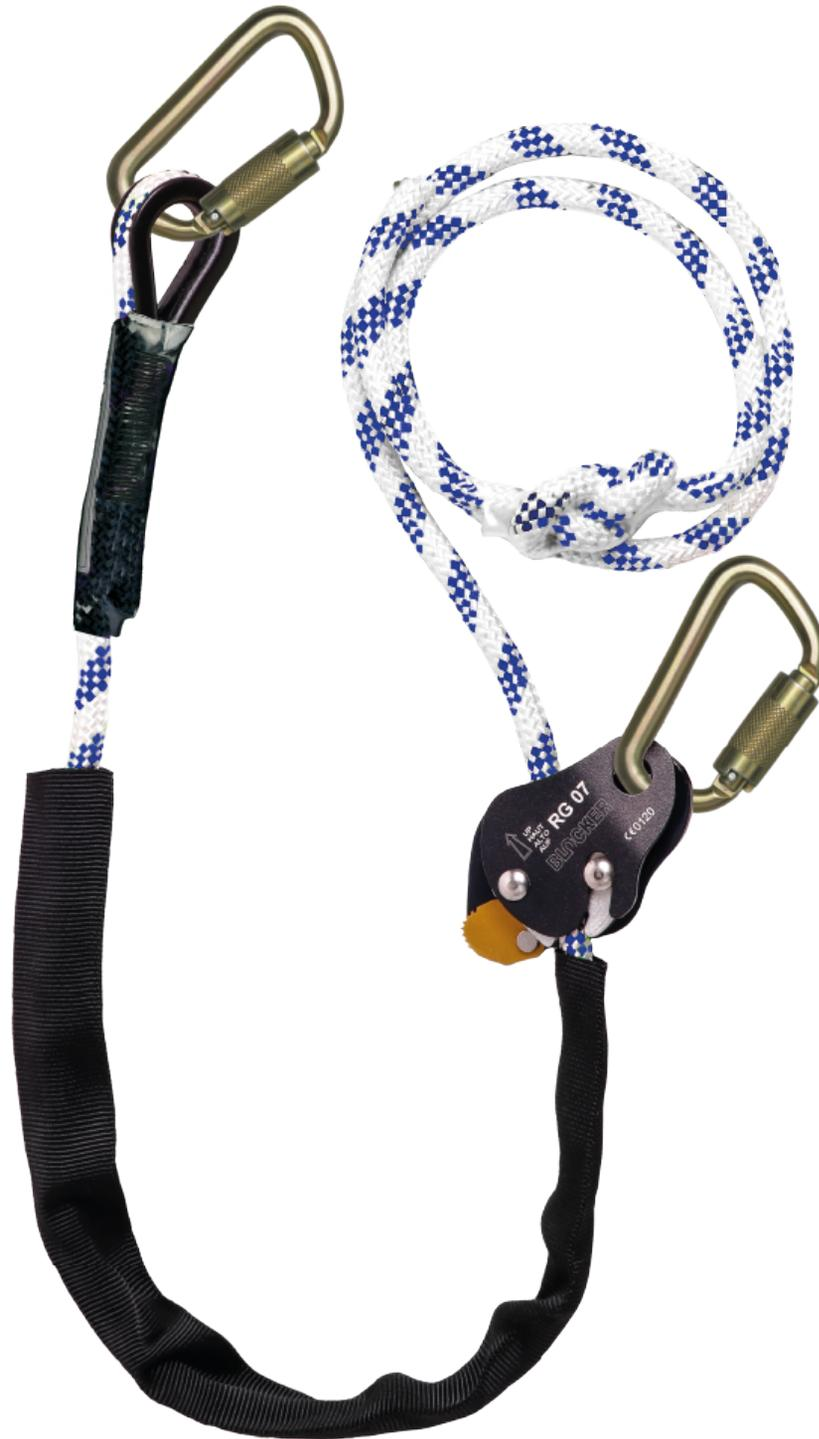
Eslinga de posicionamiento fabricada en Cuerda Kernmantle de alta tenacidad de 7/16" (11mm) de diámetro. Longitud 1.8m (6ft), con dos carabineros de acero con bloqueo de giro de 3/4" de apertura.
